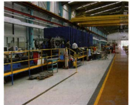
Presses de soudage des frettes : force totale environ 18 000 tonnes utilisée pour la soudure longitudinale des frettes cintrées.
